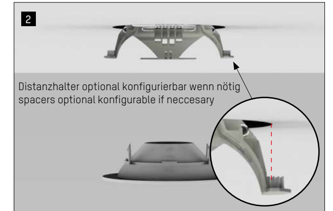
Kühlkörper in Deckenausschnitt einsetzen und Distanzhalter je nach Bedarf wegbrechen (0 - 20mm) Insert cooling body into ceiling cut-out and break away spacers as required (0 - 20mm)
