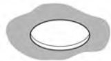
Ø cm. 8,0 Foro per cartongesso Hole for plasterboard Deckenausschnitt für Gipskarton Trou pour cloison en placoplatre Perforación para falso techo
