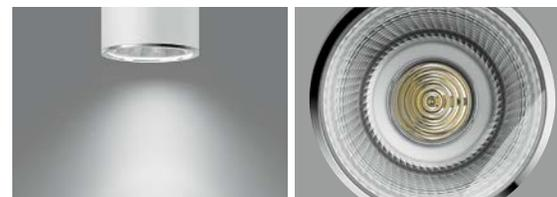
**Ringkronen mit BEGA Hybrid Optics®** sind Tiefstrahler mit breitstreuender Lichtstärkeverteilung. Diese Optik nutzt die Vorteile sowohl der Linsen- als auch der Reflektortechnik. Das Resultat sind hocheffiziente, verlustarme und optimal entblendete, nach oben und unten geschlossene optische Systeme bei sehr kompakten Abmessungen. Ringkronen mit dieser Lichttechnik bestechen durch ihre sehr hohe Lichtausbeute und ihr hohes Maß an lichttechnischer Qualität.
