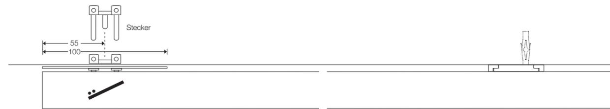
Deckenschiene mit Einspeisung, links oder rechts
