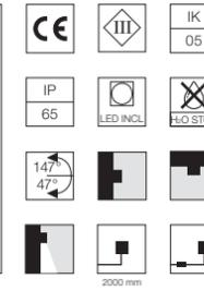
Inklusive LED-Quelle. Die 24 V Gleichstrom ON/OFF Fernstromversorgung muss separat bestellt werden. Ausgestattet mit einem 2000 mm überstehenden Neoprenkabel und einer 2-poligen und 3-Wege Anschlussdose mit H2O-STOP-System, die die Dichtigkeit des Anschlusses garantieren. Inklusive Metallstift zur Bodenmontage. Extraklares transparentes Glas. Dimmbare Version auf Anfrage erhältlich.
