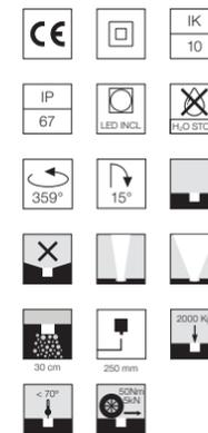
Inklusive LED-Lichtquelle. Integrierte elektrische 24V-Gleichstrom-Fernstromversorgung ON/OFF. Neigung auf der vertikalen Achse: Max. 15°. Rotation auf der horizontalen Achse: Max. 359°. Fernstromversorgung, die in einer Anschlussdose untergebracht werden muss, ausgestattet mit einem 400 mm überstehenden Kabel mit einem M12 Gewindeanschluss, der die Wasserdichtigkeit der Leuchte garantiert und einem 250 mm Kabel für den Anschluss an die Stromleitung. Extraklares transparentes Glas.
