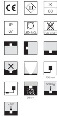
Inklusive LED-Quelle. Die 24 V Gleichstrom-Fernstromversorgung muss separat bestellt werden. Die Montage benötigt eine Einbaudose, die separat bestellt werden muss. Die Leuchte ist ausgestattet mit einem 200 mm überstehenden Neoprenkabel mit einem integriertem H2O STOP Anschlussystem und einem Set mit Crimpverbindern und selbstklebenden Schrumpfschläuchen, die die Dichtigkeit des Anschlusses garantieren. Glas mit opalem Diffusor. Dimmbar.
