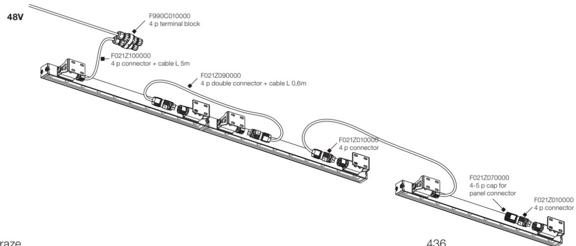
Schaltplan Nr.4 / Wiring diagram n.4
