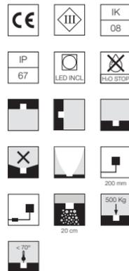
Inklusive LED-Quelle. Die 24 V Gleichstrom-Fernstromversorgung muss separat bestellt werden. Die Montage benötigt eine Einbaudose, die separat bestellt werden muss. Die Leuchte ist ausgestattet mit einem 200 mm überstehenden Neoprenkabel und einem Set mit Crimpverbindern und selbstklebenden Schrumpfschläuchen, die die Dichtigkeit des Anschlusses garantieren. Glas mit opalem Diffusor. Dimmbar.
