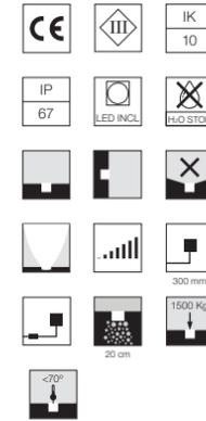
Inklusive LED-Quelle. Die 24 V Gleichstrom-Fernstromversorgung muss separat bestellt werden. Die Montage benötigt eine Einbaudose, die separat bestellt werden muss. Die Leuchte ist ausgestattet mit einem 300 mm überstehenden Neoprenkabel und einem Set mit Crimpverbindern und selbstklebenden Schrumpfschläuchen, die die Dichtigkeit des Anschlusses garantieren. Glas mit opalem Diffusor. Dimmbar.
