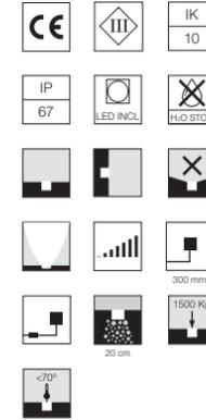
Inklusive LED-Quelle. Die 24 V Gleichstrom-Fernstromversorgung muss separat bestellt werden. Die Montage benötigt eine Einbaudose, die separat bestellt werden muss. Die Leuchte ist ausgestattet mit einem 300 mm überstehenden Neoprenkabel und einem Set mit Crimpverbindern und selbstklebenden Schrumpfschläuchen, die die Dichtigkeit des Anschlusses garantieren. Glas mit opalem Diffusor.
