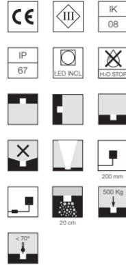
Inklusive LED-Quelle. Die 24 V Gleichstrom-Fernstromversorgung muss separat bestellt werden. Die Montage benötigt eine Einbaudose, die separat bestellt werden muss. Die Leuchte ist ausgestattet mit einem 200 mm überstehenden Neoprenkabel und einem Set mit Crimpverbindern und selbstklebenden Schrumpfschläuchen, die die Dichtigkeit des Anschlusses garantieren. Extraklares transparentes Glas. Dimmbare Version auf Anfrage erhältlich.
