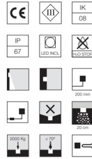
Inklusive LED-Quelle. Die 24 V Gleichstrom-Fernstromversorgung muss separat bestellt werden. Die Montage benötigt eine Einbaudose, die separat bestellt werden muss. Die Leuchte ist ausgestattet mit einem 200 mm überstehenden Kabel und einem Kabelset mit Crimpverbindern und selbstklebenden Schrumpfschläuchen, die die Dichtigkeit des Anschlusses garantieren. Dimmbare Version auf Anfrage erhältlich.
