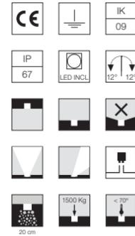
Inklusive LED-Quelle. Integrierte Stromversorgung 220-240 V ON/OFF und dimmbar 1-10 V oder DALI. Einstellung auf der vertikalen Achse: max. 12°. Die nötige Anschlussdose oder die Struktur für die Montage auf Gipskarton müssen separat bestellt werden. Mit zwei M20 Kabelführungen (6<math>< \phi</math><math>< 12</math> mm Kabel) für den Anschluss zum wasserdichten elektrischen Modul. Extraklares transparentes Glas.
