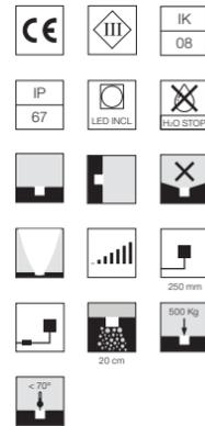
Inklusive LED-Lichtquelle. 240V Fernstromversorgung, die separat bestellt werden muss, ON-OFF und dimmbar 1-10V oder DALI. Die Montage benötigt eine Einbaudose, die separat bestellt werden muss. Die Leuchte ist ausgestattet mit einem 250 mm überstehenden Neoprenkabel mit einem integriertem H2O STOP Anschlussystem und einem Set mit Crimpverbindern und selbstklebenden Schrumpfschläuchen, die die Dichtigkeit des Anschlusses garantieren. Mattiertes Glas.
