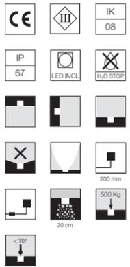
Inklusive LED-Quelle. Die Fernstromversorgung mit DMX-3chx350mA-Schnittstelle muss separat bestellt werden. Die Montage benötigt eine Einbaudose, die separat bestellt werden muss. Die Leuchte ist ausgestattet mit einem 200 mm überstehenden Neoprenkabel und einem Set mit Crimpverbindern und selbstklebenden Schrumpfschläuchen, die die Dichtigkeit des Anschlusses garantieren. Extraklares transparentes Glas.
