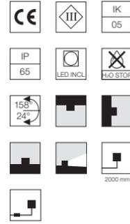
Inklusive LED-Quelle. Die 24 V Gleichstrom ON/OFF Fernstromversorgung muss separat bestellt werden. Ausgestattet mit einem 2000 mm überstehenden Neoprenkabel und einem Set mit Crimpverbindern und selbstklebenden Schrumpfschläuchen, die die Dichtigkeit des Anschlusses garantieren. Inklusive Befestigungsbügel. Der Metallstift zur Bodenmontage muss separat bestellt werden. Extraklares transparentes Glas. Dimmbare Version auf Anfrage erhältlich.
