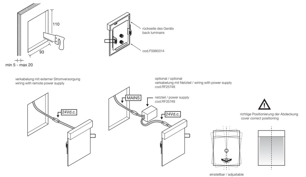
Einbau in Mauerwerk ohne Einbaugehäuse / Installation in Masonry without Box for Installation
