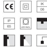
Inklusive LED-Quelle. Integrierte elektrische Stromversorgung 220-240 V ON/OFF. Mit IP65 Kabelführung für Gummikabel 5 mm<math>\phi</math><math><9\text{ mm}</math> und einer Anschlussdose für einen schnellen Anschluss. Um die Dichtigkeit der Kabelführung zu gewährleisten, wird empfohlen, flexible Elektrokabel zu verwenden, die für den Außeneinsatz geeignet sind.
