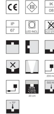
Inklusive LED-Quelle. Die 24 V Gleichstrom-Fernstromversorgung muss separat bestellt werden. Die Montage benötigt eine Einbaudose, die separat bestellt werden muss. Die Leuchte ist ausgestattet mit einem 200 mm überstehenden Neoprenkabel mit einem integriertem H2O STOP Anschlussystem und einem Set mit Crimpverbindern und selbstklebenden Schrumpfschläuchen, die die Dichtigkeit des Anschlusses garantieren. Extraklares transparentes Glas. Dimmbare Version auf Anfrage erhältlich.
