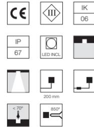
Inklusive LED-Quelle. Die 24 V Gleichstrom-Fernstromversorgung muss separat bestellt werden. Mit Feder für Gipskarton-Installationen. Die Leuchte ist ausgestattet mit einem 200 mm überstehenden Neoprenkabel und einem Set mit Crimpverbindern und selbstklebenden Schrumpfschläuchen, die die Dichtigkeit des Anschlusses garantieren. Transparenter Polycarbonat-Diffusor. Dimmbare Version auf Anfrage erhältlich.
