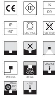
Inklusive LED-Quelle. Die 24 V Gleichstrom-Fernstromversorgung muss separat bestellt werden. Die Montage benötigt eine Einbaudose, die separat bestellt werden muss. Die Leuchte ist ausgestattet mit einem 250 mm überstehenden Kabel und einem wasserdichten M12-Gewindeanschluss. Optionales Zubehör: 5000 mm und 300 mm Verteilerkabel mit M12-Gewindeanschlüssen für mehrfache Installationen.
