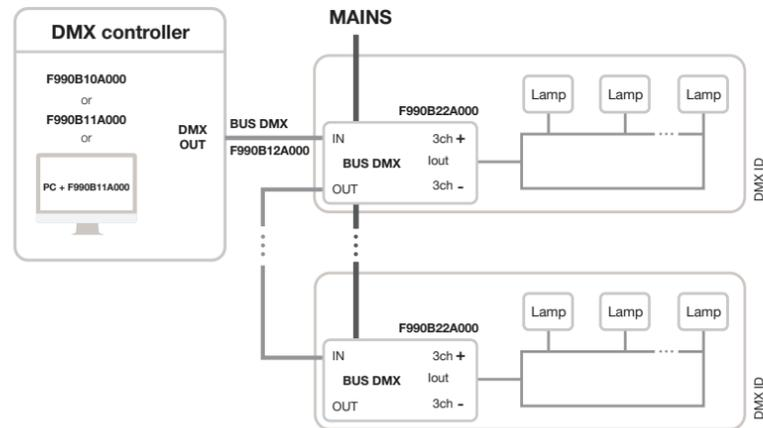
Schaltplan und Beispielinstallation / Wiring Diagram and sample installation.
