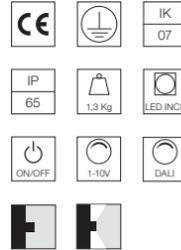
Inklusive LED-Lichtquelle. Integrierte Spannungsversorgung 220-240 V ON/OFF und dimmbar 1-10 V oder DALI. Ausgestattet mit doppelten Kabeldurchführungen für den Eingangs- und Ausgangsanschluss. Version Monoemission nach oben oder Monoemission nach unten auf Anfrage.
