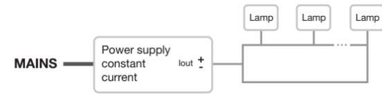
Schaltplan und Beispiel für eine Parallelschaltung / Wiring Diagram and sample parallel installation
