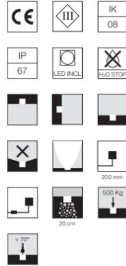
Inklusive LED-Quelle. Die 24 V Gleichstrom-Fernstromversorgung muss separat bestellt werden. Die Montage benötigt eine Einbaudose, die separat bestellt werden muss. Die Leuchte ist ausgestattet mit einem 200 mm überstehenden Neoprenkabel mit einem integriertem H2O STOP Anschlussystem und einem Set mit Crimpverbindern und selbstklebenden Schrumpfschläuchen, die die Dichtigkeit des Anschlusses garantieren. Glas mit opalem Diffusor. Dimmbar.
