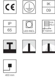
Inklusive LED-Quelle. Integrierte Stromversorgung 220-240 V ON/OFF und dimmbar 1-10 V oder DALI. Inklusive Befestigungsbügel. Ausgestattet mit einem 400 mm überstehenden Neoprenkabel und IP68-Doppelte Fassung für 102-mm-Pfosten. Der Pfosten muss separat bestellt werden. Smart-City-Version auf Anfrage erhältlich.
