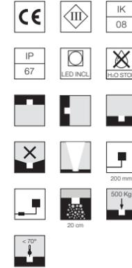
Inklusive LED-Quelle. Die 24 V Gleichstrom-Fernstromversorgung muss separat bestellt werden. Die Montage benötigt eine Einbaudose, die separat bestellt werden muss. Die Leuchte ist ausgestattet mit einem 200 mm überstehenden Neoprenkabel mit einem integrierten H2O STOP Anschlussystem und einem Set mit Crimpverbindern und selbstklebenden Schrumpfschläuchen, die die Dichtigkeit des Anschlusses garantieren. Extraklares transparentes Glas. Dimmbare Version auf Anfrage erhältlich.
