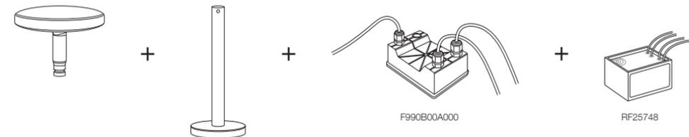
Dimmbar DALI = Produktcode (F004C30A001 + F004Z010001) + Netzteil 35 W / 120-270 Vac / 24 Vdc DALI-PWM-Steuerung IP67 (F990B03A000)
