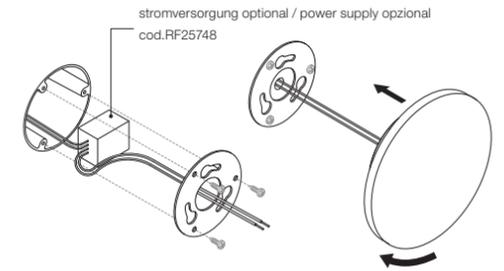
einbauehäuse mit der Wand bündig
