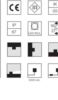
Inklusive RGB LED-Quelle. Die Fernstromversorgung mit DMX-3chx350mA-Schnittstelle muss separat bestellt werden. Serienschaltung. Ausgestattet mit einem 2000 mm überstehenden Neoprenkabel und einem Set mit Crimpverbindern und selbstklebenden Schrumpfschläuchen, die die Dichtigkeit des Anschlusses garantieren. Mattiertes Glas. Der Metallstift zur Bodenmontage muss separat bestellt werden.
