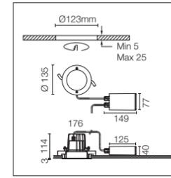
Inklusive LED-Quelle. Integrierte Stromversorgung 220-240V ON/OFF und dimmbar 1-10V oder DALI.: Fernbedienungsset mit einem 400 mm überstehenden Kabel mit einem wasserdichten M12-Gewindeanschluss an der Lampe und einem 250 mm überstehenden Kabel für den Anschluss ans Netz. Dieses muss bei gemauerten Decken in der Anschlussdose untergebracht werden (muss separat bestellt werden) oder bei Gipskarton-Zwischendecken neben der Leuchte angebracht werden Dimmbare Version auf Anfrage erhältlich.
