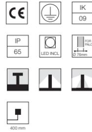
Inklusive LED-Quelle. Integrierte Stromversorgung 220-240 V ON/OFF und dimmbar 1-10 V oder DALI. Inklusive Befestigungsbügel. Ausgestattet mit einem 400 mm überstehenden Neoprenkabel und IP68-Doppelte Fassung für 76-mm-Pfosten. Der Pfosten muss separat bestellt werden. Smart-City-Version auf Anfrage erhältlich.
