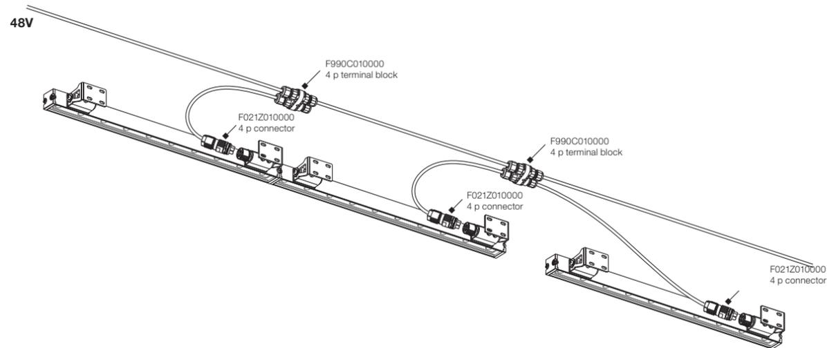
Schaltplan Nr.3 / Wiring diagram n.3
