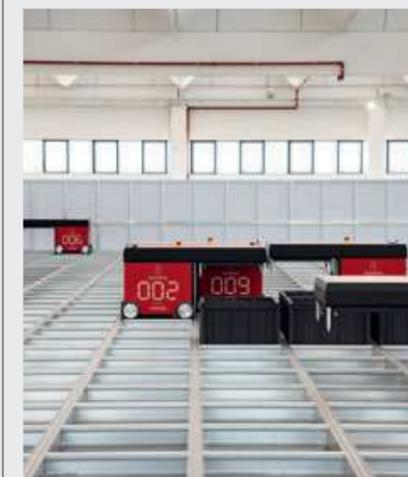
10 hochleistungsfähige Plug-and-Play-Roboter mit einem Gewicht von nur 150 kg pro Roboter und Bremsenergieerückspeicherung garantieren für einen optimalen Energieverbrauch. Auch die Arbeitsstationen wurden für geringen Energieverbrauch ausgelegt.
