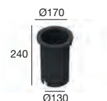
84932 Gegengehäuse für die Installation am Boden
