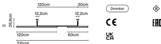
(1) Die Höhe kann durch Verlängerungsstücke (Pole) um 40 oder 60cm (max. 3 Stück, pro Seite) angepasst werden. Sie können miteinander kombiniert werden.
