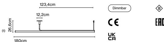
(1) Die Höhe kann durch Verlängerungsstücke (Pole) um 40 oder 60cm (max. 3 Stück) angepasst werden. Sie können miteinander kombiniert werden..
