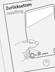
Loslassen, Leuchte blinkt für 4 Sek., dann startet die Messung. Release button, luminaire flashes for 4 seconds, then the measurement starts.
