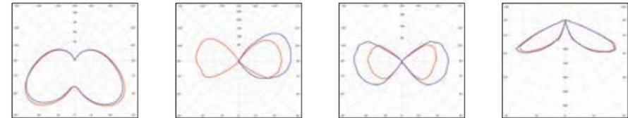
Modelle 1 bis 12 außer 2: LED 35W, Lichtstrom/opal - 1727 lm, Lichtstrom/klar - 1444 lm, CRI > 80
