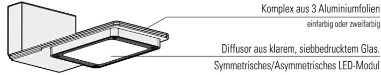
Erhältlich als Einzelkopf mit Fernbedienung für die Montage am Ø60-Mast
