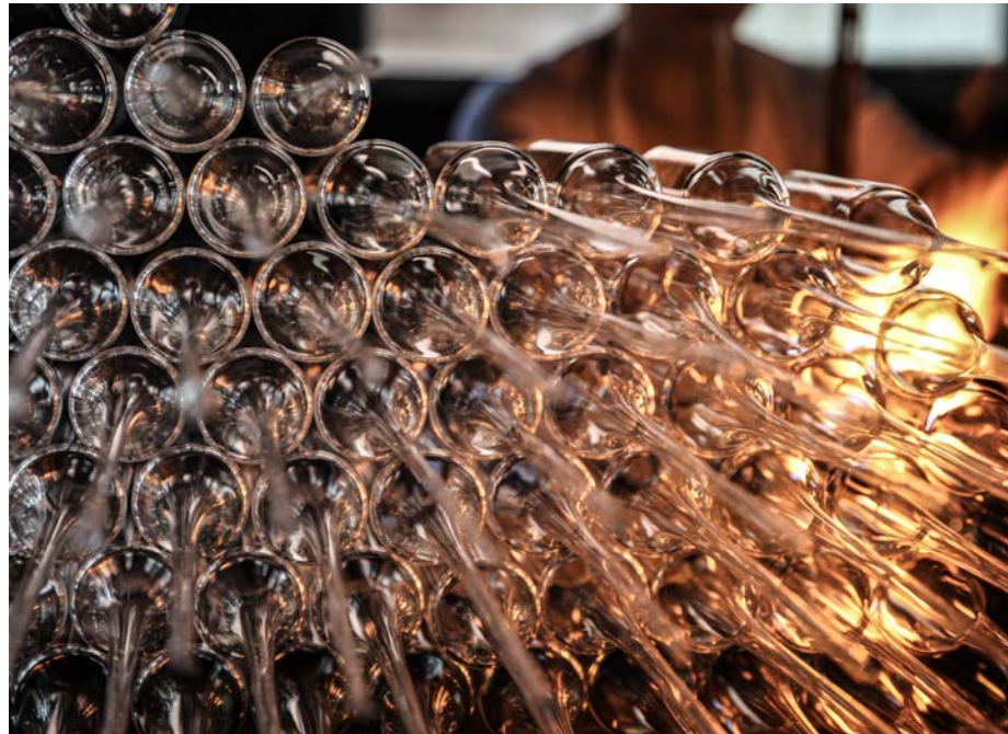
Glasrohlinge, bevor sie mundgeblasen werden
